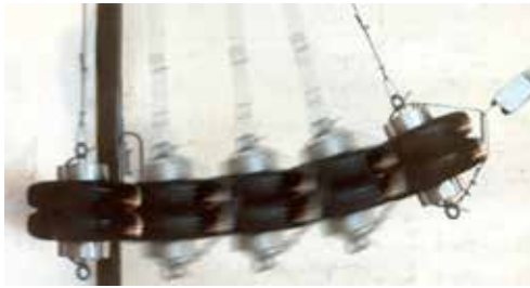
Ensayo péndulo EN 12600
