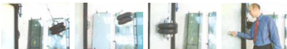
Ensayo péndulo EN 12600
